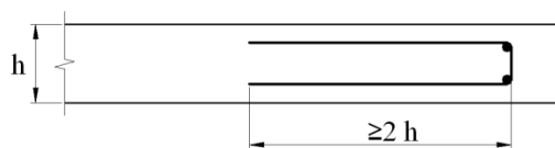
Рисунок 10.9 - Краевая арматура плиты
