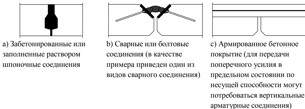
Рисунок 10.22 - Примеры соединений для передачи сдвига
